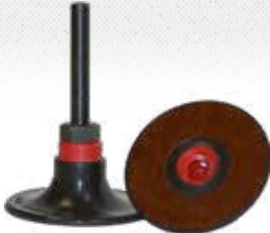
**Vorteile:** Sicheres Aufspannen der QRC-Scheiben - Optimiertes Schleifverhalten (Aggressivität, Oberflächengüte) durch zwei Härtegrade - Einfache Unterscheidung der Härten durch Farbringe - Spannstift abschraubbar, dadurch Einsatz auf Winkelstabschleifer oder mit QCA 555-Adapter möglich
