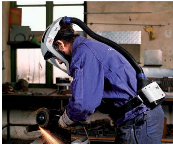
**Wir unterscheiden zwischen Gebläsesystemen, die von der Umgebungsluft abhängig sind, und Druckluftsystemen, die von der Umgebungsluft unabhängig sind.**
