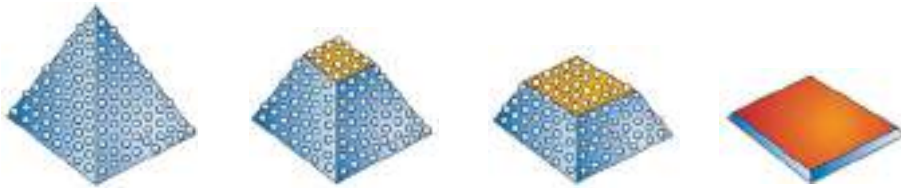
Abschleifverhalten der Pyramidenstruktur
