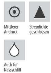
Universell einsetzbares, leistungsstarkes Aluminiumoxid-Schleifmittel auf robustem Polyester- oder Baumwollgewebeträger. Das große Körnungsspektrum macht es zum Allrounder: Es kann für Entgratungsarbeiten mit P24, zum Beispiel nach dem Laser- oder Wasserstrahlschneiden eingesetzt werden. Zudem hält es extremen Belastungen wie scharfen Kanten oder spitzen Graten stand und kann darüber hinaus mit P400 auch bei Polierarbeiten zum Einsatz kommen.
