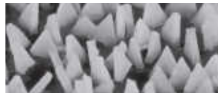
Optimale Ausrichtung des VICTOGRAIN-Schleifkorns
