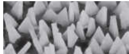
Optimale Ausrichtung des VICTOGRAIN-Schleifkorns
